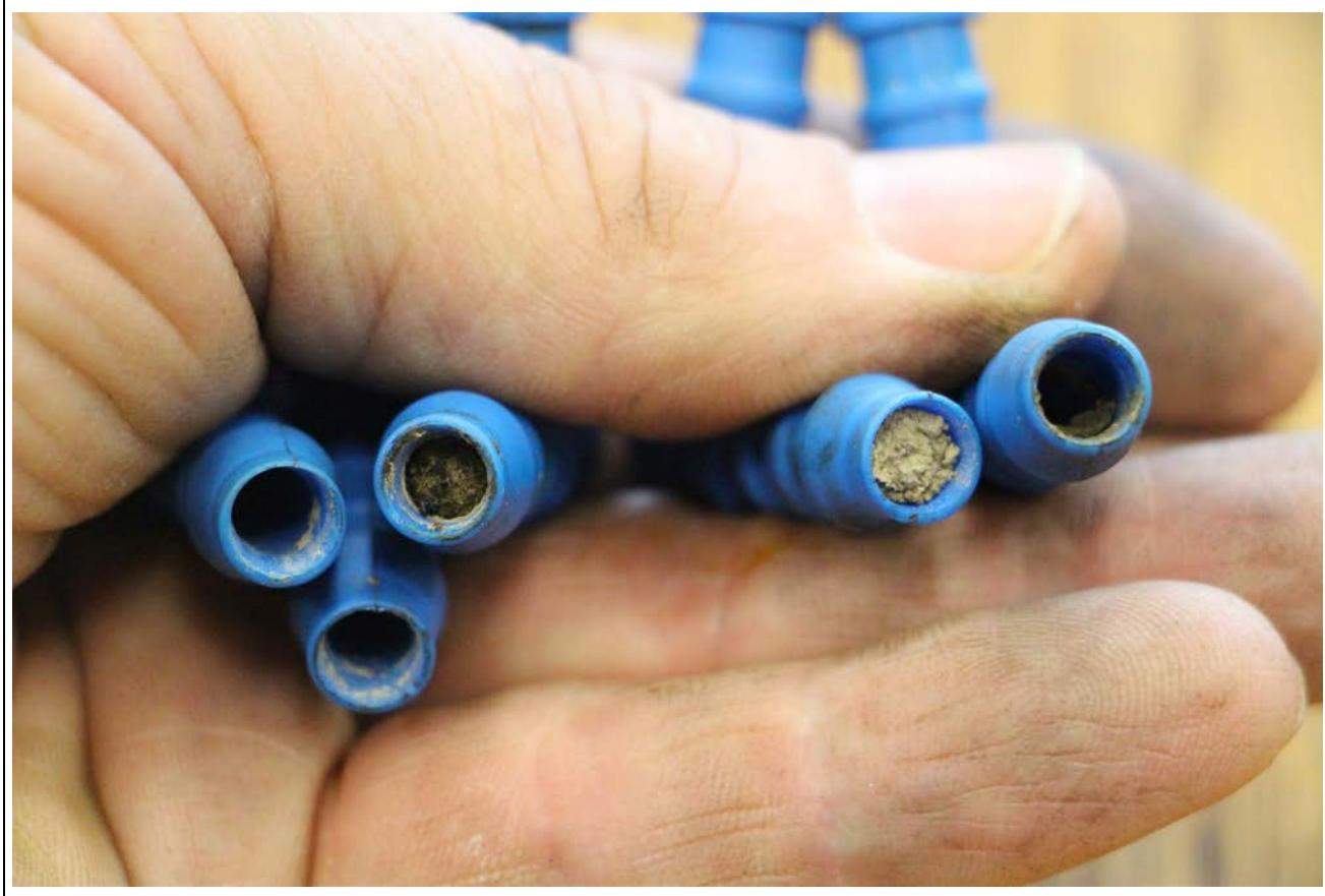
Durch das Vakuum wurden feine Partikel durch das ganze System verteilt. Dies wiederum führte zu Defekten an den Kupplungen, die dann undicht wurden. Eine kleine Unbedachtheit, beim Umgang mit dem Vakuumhebegerät, führt so zu einem relativ großen Schaden.
