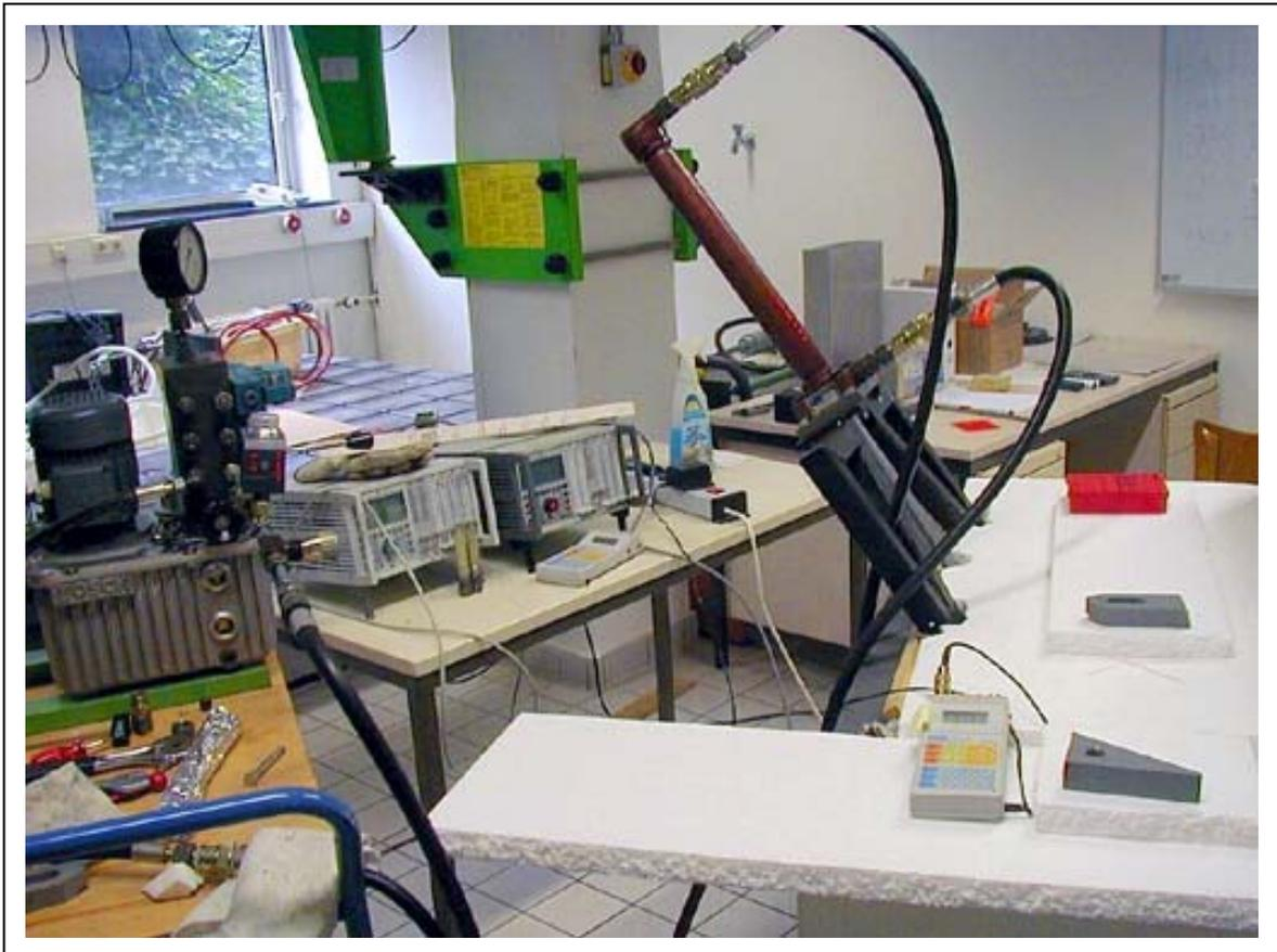
Das Foto zeigt die Situation während des Zugversuchs, vorn die Temperaturanzeige für die Messstelle am Sauger.
