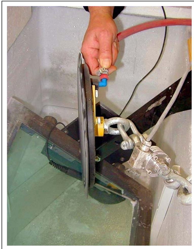
Das Foto zeigt, bei  $-30,8^{\circ}\text{C}$  ist der Sauger steifgefroren und funktionsunfähig.
