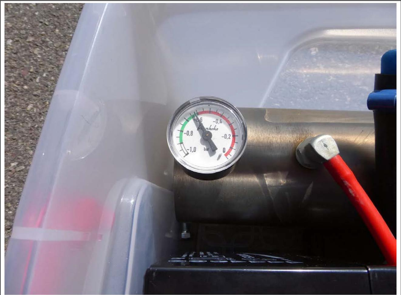
In dieser Höhe wird ein normales batteriebetriebenes Vakuumhebegerät nur noch mit laufender Vakuumpumpe arbeiten können und hätte keine Reserve mehr zur Verfügung.
