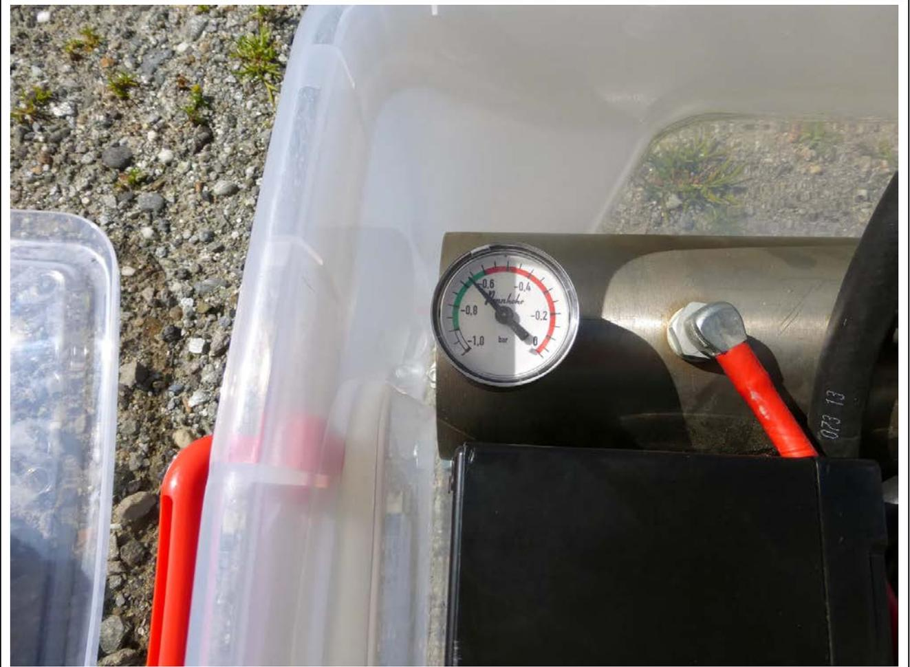
In dieser Höhe wird ein normales batteriebetriebenes Vakuumhebegerät nur noch mit laufender Vakuumpumpe arbeiten können.
