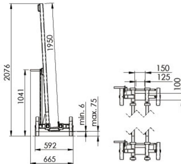
Fahrwerk mit Stahlplatte
