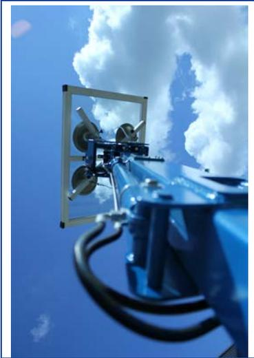
Der fahrbare Vakuum-Manipulator für die Verglasung, Fenstermontage, Montage von Fassadenelementen oder für den Einsatz in der Produktion.
